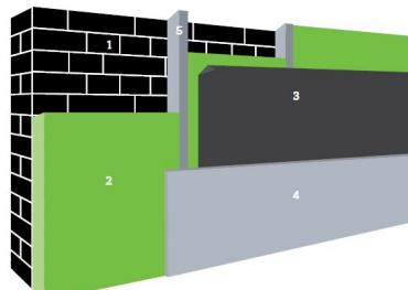
1. Buitenumuur | 2. Isolatie | 3. Vochtscherm | 4. Afwerkingslaag | 5. Stijl- en regelwerk (optioneel)
