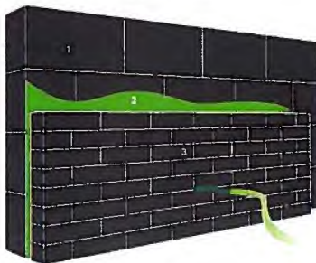
1. Dragende muur | 2. Ingeblazen isolatie | 3. Gevelsteen / gevelbekleding
